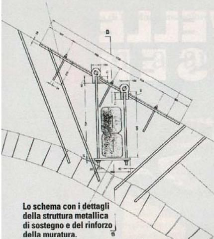
Lo schema con i dettagli della struttura metallica di sostegno e del rinforzo della muratura.
